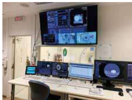
装操作室に 65 インチモニターを設置し、監視カメラ・生体モニター・CT 画像を表示し、多くのスタッフが観察できるようにしている
