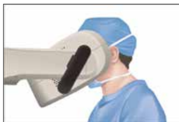
図 3 姿勢の自由度の高いサージョンコックピットのモニター
